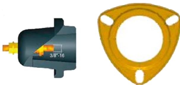
Imagens ilustrativas da bucha primária tipo poço (Bushing well) - (figuras 14 e 15)
