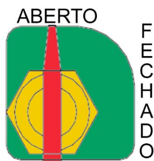
Imagem ilustrativa da chave Seccionadora (figura 10)
